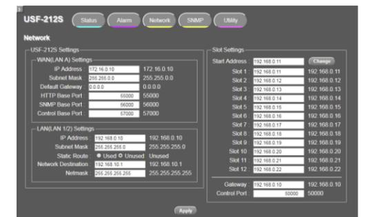
USF-212S は内部の USF モジュールについても IP アドレスが割り当てられています。IP アドレス設定の詳細は、USF-212S 取扱説明書「10. USF-212S WEB GUI」を参照してください。
