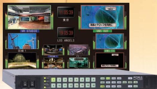
SMPTE ST 2110<sup>\*1</sup> および 2022-6 におけるリダンダント環境<sup>\*2</sup>の IP ストリームに対応し、最大 HD 16 入力または 4K 4 入力<sup>\*3</sup>、および HD 4 出力が可能。12G-SDI または HDMI 出力により 4K モニターへ出力してフレキシブルなレイアウトが可能。柔軟なレイアウト等、ベースバンド向けの MV シリーズと同等の機能、操作性を継承。従来の操作性での IP システム運用をサポート。
