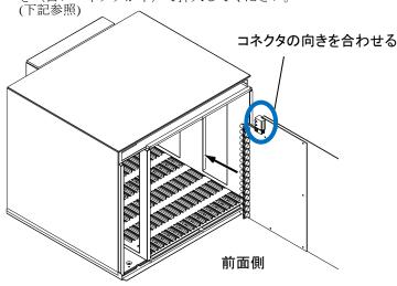
(5) ネジを持って両側の固定プレートを外側に広げ、ネジを締めます。
