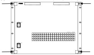
(3) 両側の固定プレートのネジを緩め、固定プレートを内側に引き込みます。
