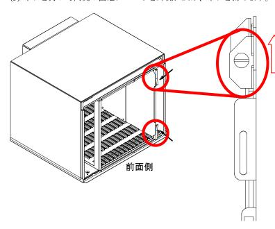
(6) 付属のバインドネジで背面の上下にパネルスペーサを 取り付けます。 (パネルスペーサは上下でサイズが異なります。)
