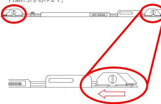
(4) 白いコネクタの向きを合わせて、MFR ユニットの前面から入出力 基板を挿入します。MFR-8000 の場合、上段には下図と上下逆の向 き(白いコネクタが下)で挿入してください。
