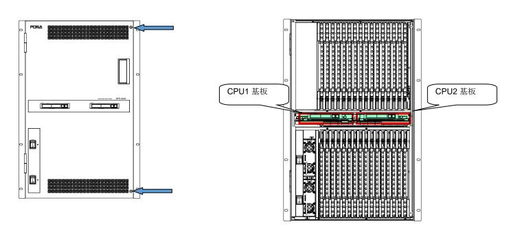
下図のようにマトリクス基板のシールド板に CPU 基板が実装されているため、先に CPU 基板を引き抜く必要があります。
