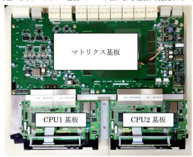
(3) CPU1 基板を引き抜きます。CPU 基板の左右にある黒い取っ手を持ち、CPU 基板を引き抜きます。
