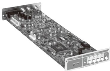
CSFフレームに効率良く実装可能なモジュラタイプのビデオタイマ。集中監視システムなどに最適。
