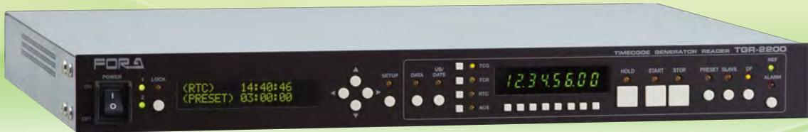
S-BCD (シリアル時刻) 信号、リアルタイムクロック (内蔵時計) により時刻補正したタイムコードの生成、外部入力のタイムコードに追従したタイムコード (スレーブロックモード) の出力が可能。オプションの TGR-22LAN を追加することで、Web ブラウザーからの制御、SNMP による監視、NTP による時刻補正も可能。
