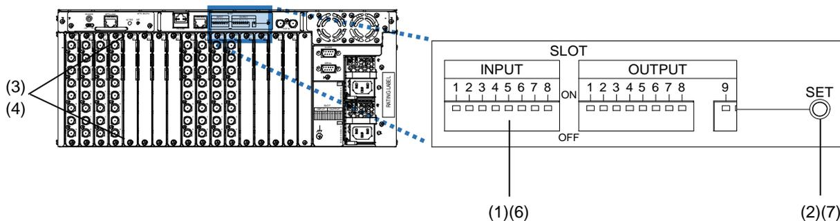
(2) SET スイッチを 1 秒以上押します。スロット 5 の電源が OFF になります。
