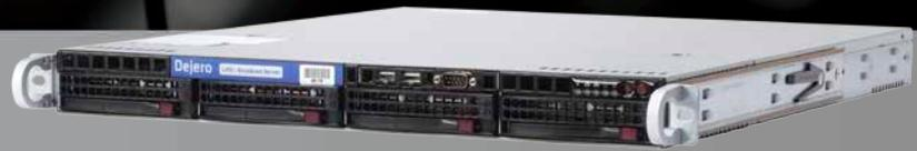
Dejero Broadcast Serverは、DejeroトランスミッタシリーズからIPネットワークを介して伝送されるビデオを受信し、再構成し、お客様のSDI送出ワークフローへと出力します。既存施設のサーバ・ラックに設置できるように、あるいは使用中の放送インフラへシームレスに融合できるように、デザインされています。1Uの筐体を持つBroadcast Serverは、放送業界のワークフローに合わせて、確実に動作させるよう安全性を考慮した二重化電源とRAIDハードドライブを組み込んでいます。
