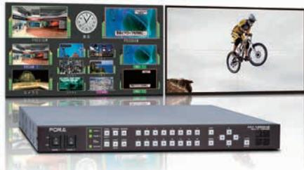
4K入力対応のマルチビューワー。3G-SDI (Level-A/B)、HD-SDI、SD-SDI、アナログコンポジット信号の混在入力が可能。最大16入力2出力、カスケード接続により最大64分割表示。フリーレイアウト、オーディオレベル表示、AFD対応クロッピング機能、インフォメーションディスプレイ機能など多彩な機能を搭載。デュアルモニター、最大20ウィンドウ対応。
