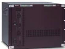
8RUサイズの筐体に最大で128 x 128のマトリクス構成が可能。入出力は16チャンネル単位で増設可能で、8入出力の8K伝送、32入出力の4K UHD伝送が可能。RS-422インターフェースのルーティングにも対応。
