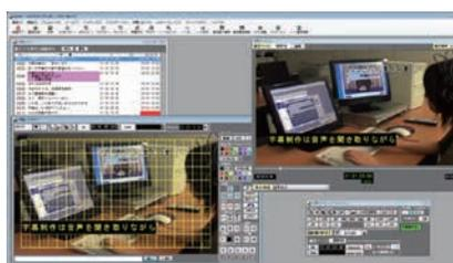
地上デジタル放送向け機能を強化した、字幕制作システム\*1。MPEG-1、MPEG-2、H.264/MP4およびXDCAMプロキシファイルを使用した字幕制作が可能。話速変換機能\*\*2を搭載し、字幕データ作成を効率化。JustRight!6 Pro\*\*3との連携による文書校正機能を搭載。
