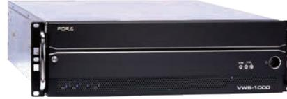
12G-SDIに対応可能なテロップ送出機。専用ハードウェアを使用することで、高度な安定性と堅牢性を両立。3RUサイズの筐体に、テロップ送出機能に加えて、動画送出機能、ミキサー機能を搭載。動画へのスーパーインポーズや3Dテロップの合成も可能。
