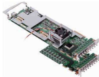
キャラクタージェネレーター用プラットフォーム。Video/Key処理可能なマルチレイヤーミキサーが搭載されており、動画へのスーパーインポーズ、3Dテロップの合成が可能。MBP-2144WS-12Gは12G-SDIにて1系統の4Kテロップ送出、PREV V出力が可能。
