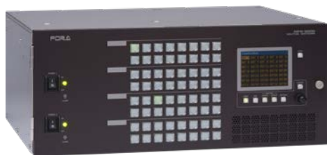
フロントコントロールパネルMFR-30FP実装 (オプション)
