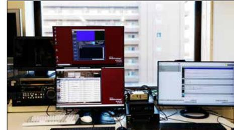
写真左:テレビ北海道様はファイルベース運用とテロップ運用の双方で扱えるMBP-1100VS-IPを導入し、ファイルベース/テロップ統合システムとして活用
