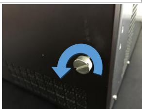
(2) フロントパネルを少し開け、上方にスライドさせて取り外します。MFR-3000 にラックイヤーがついている場合は、ラックイヤーのネジを緩めます。
